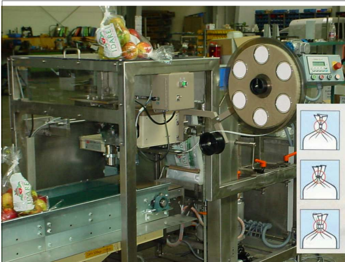
Abb.: Folien-Füll- und Verschließmaschine „FW 1 A“ Picture: Version für Äpfel mit Kwik-Lock-Verschluss Wicketed Poly Bagging Machine „FW 1 A“ Version for soft fruit with Kwik-Lock-Sealer
